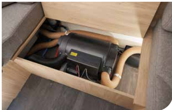
Heizung / Warmwasser (10L) TRUMA COMBI 6E (230V/GAZ)
